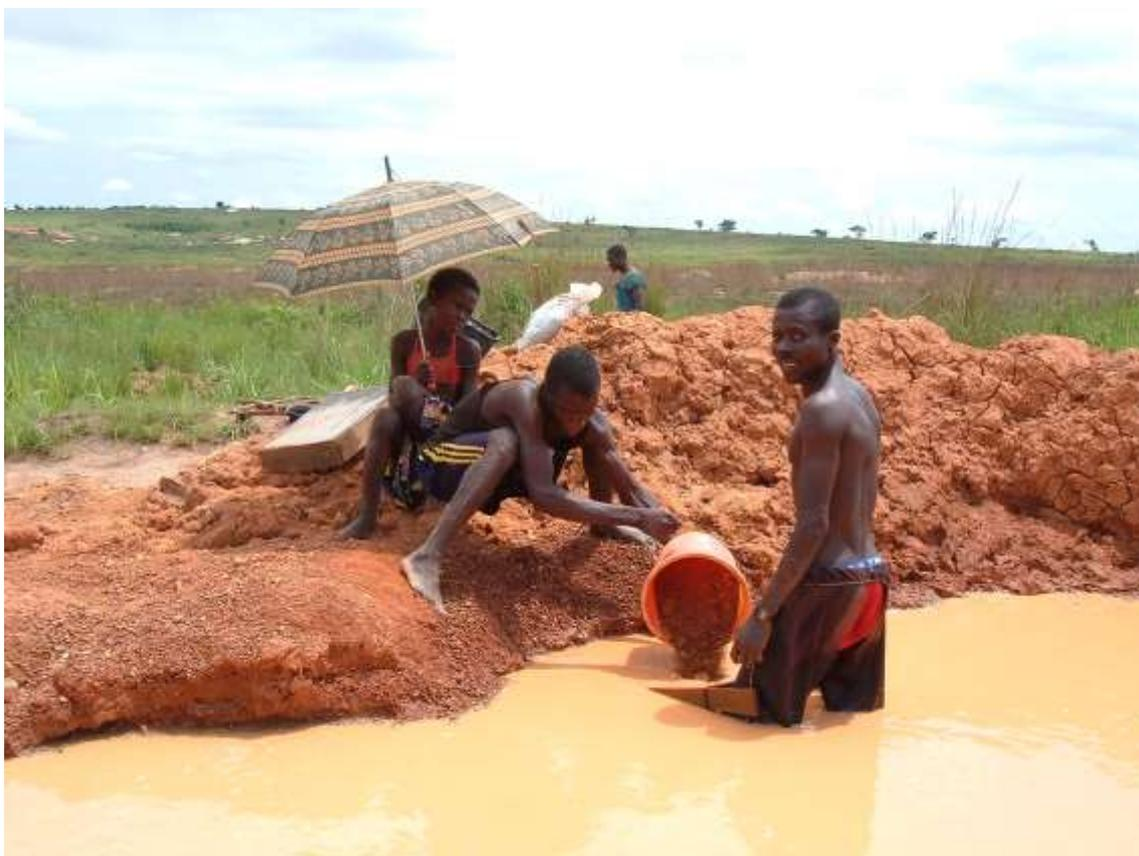
ダイヤモンドが含まれる土、砂利を水で洗い、ダイヤモンドを見つけ出す選鉱作業中の労働者
