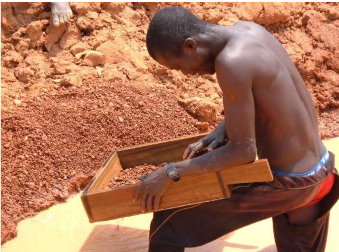
選鉱作業中の労働者。土、砂利を洗い流した後に残るダイヤモンド原石を探している。
