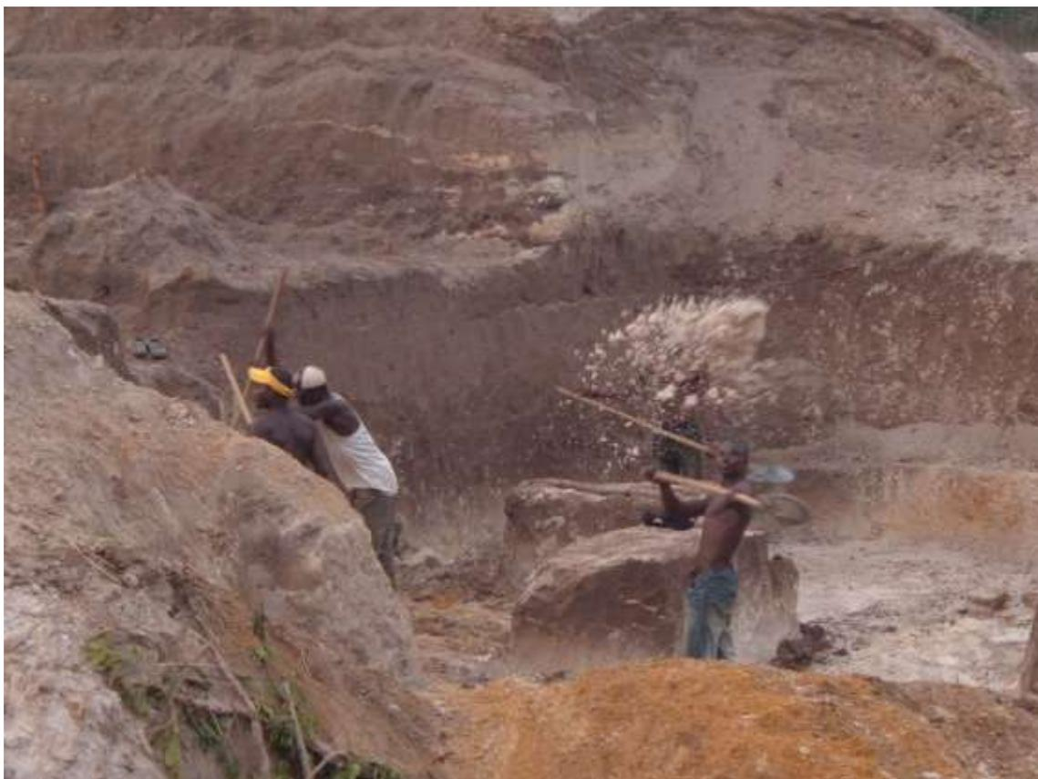
ダイヤモンド原石が含まれる土、砂利を掘り出す、手掘り採掘労働者
